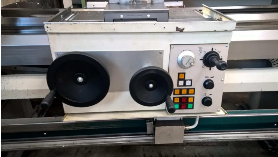
Schlosskasten mit Bedienfeld
